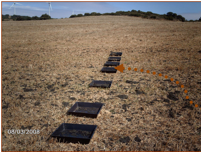
Pase del carro aplicador y recogida de la muestra en las bandejas (Foto 2)
